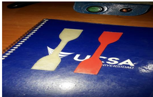
Figura 10: Probetas hechas por nuestra impresora. (Elaboración propia, 2023).
