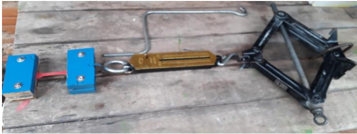
Figura 11: Prototipo de prueba de tracción. (Elaboración propia, 2023)
