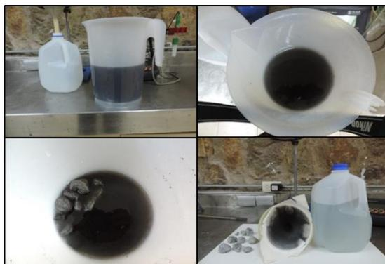
Figura 9. Obtención de  $\text{Al}_2(\text{SO}_4)_3$  por reacción de botones de la fundición de chatarra de Al con solución de  $\text{H}_2\text{SO}_4$
