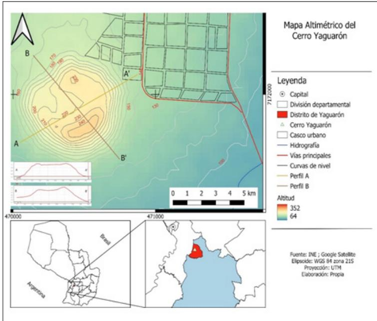
**Figura 4.** Mapa de elevación y corte topográfico del cerro Yaguarón.
