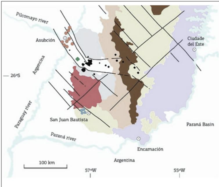
**Figura 2.** Mapa geológico esquemático de la región centro sur del Paraguay mostrando el Rift de Asunción como una estructura limitada por lineamientos. El *diamante verde* muestra la ubicación del Cerro Yaguarón en el centro de esta estructura.
