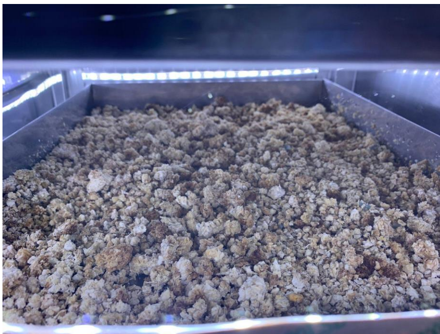
Figura 3. Sustrato olote inoculado con Trichoderma asperellum TF7 al inicio de la fermentación.
