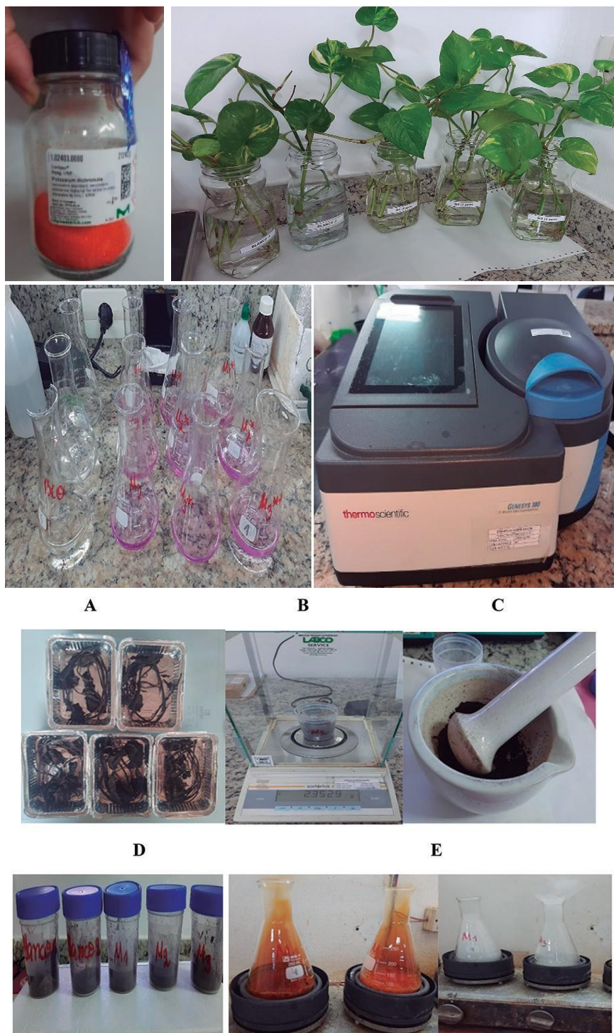
Figuras 4-7. Procedimientos laborales. 4) Patrón de Dicromato de potasio, MRC. 5) Montaje del ensayo de fitorremediación, Laboratorio de Calidad de Agua, FACEN. 6) Desarrollo de color de muestras y equipo Espectrofotómetro UV-visible, Laboratorio de Calidad de Agua, FACEN. 7) Tratamiento preliminar de tejido pos fitorremediación. A) Muestra seca a 75°C. B) Pesaje de muestra seca. C) Trituración. D) Resguardo de material triturado. E) Digestión de tejido triturado.
