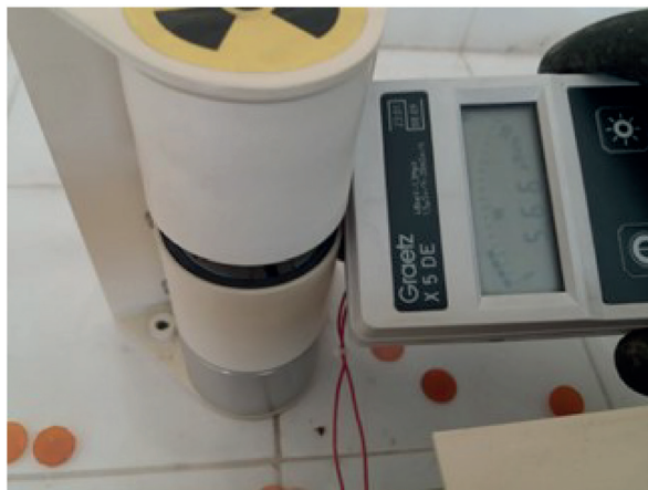
Figura 6. Monitoreo de nivel de radiación con detector Geiger Muller.
