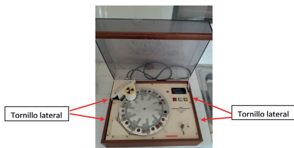
Figura 1. Equipo irradiador de dosímetros con Sr-90/Y-90 Vinten Instruments.
