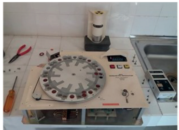
Figura 5. Blindaje con las fuentes radiactivas desmontadas sin electroimán (obturador cerrado).
