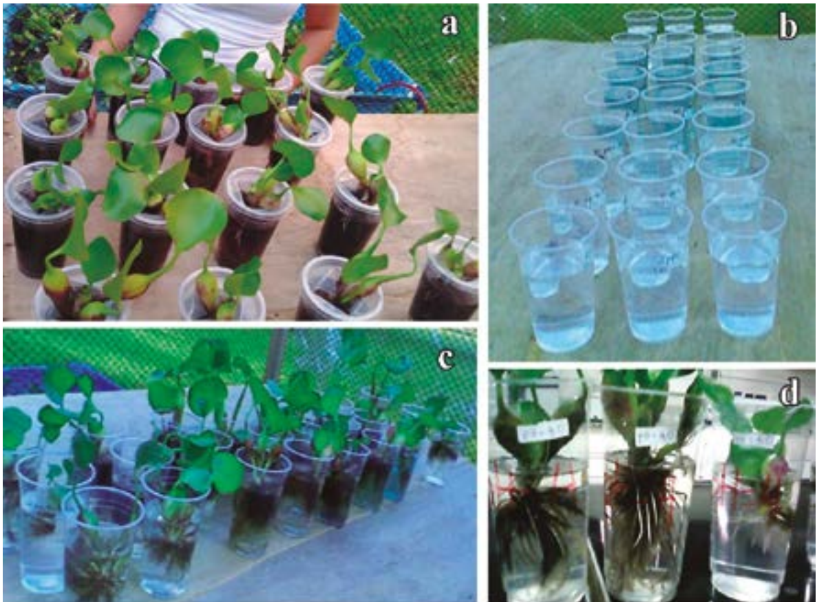
Figura 3. Ensayo de tolerancia. a) Eichhornia crassipes en solución de Cromo. b) Control positivo. c) Control negativo. d) Control de pH.
