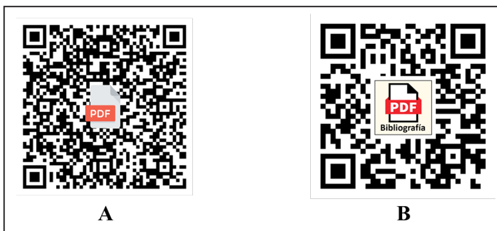
Figura 1. Comparación entre (A): un Código QR de alta densidad modular con un logo que indica que al decodificarlo se puede acceder a un archivo en formato pdf y (B): un Código QR con complemento de función de baja densidad modular con una imagen vectorial de mayor tamaño indicando el mismo tipo de archivo pdf y el contenido del material que se descarga, que en este caso corresponde a un material bibliográfico.
